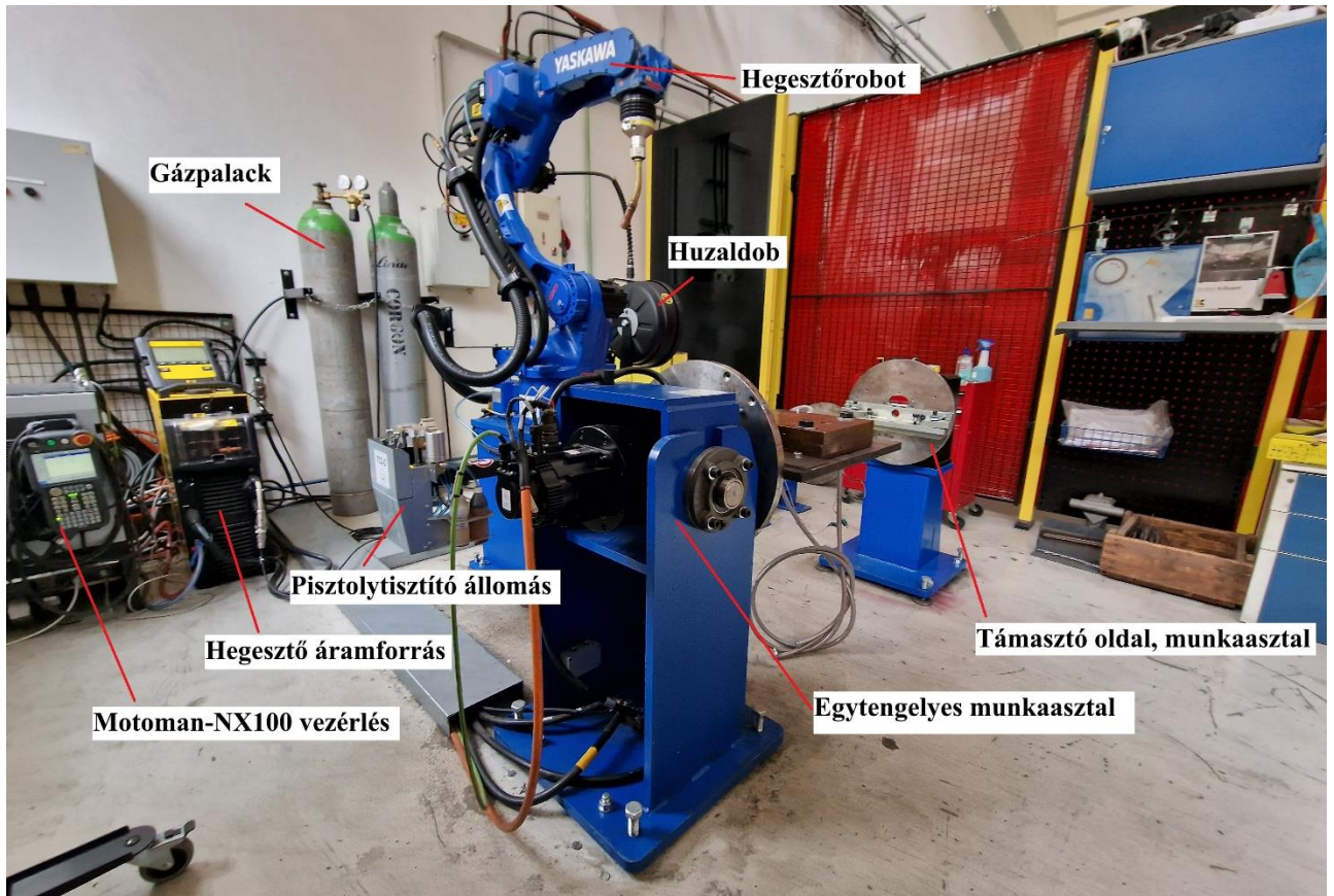
A robotcella felépítése
